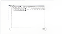
Figura 4 Quando il pannello elettronico arriva al margine destro, torna all'«inizio» sulla «riga» superiore.
